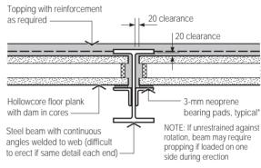
INTERNAL SHELF ANGLE ON STEEL BEAM DETAIL
